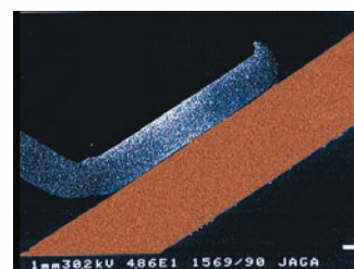
Obraz mikroskopowy aluminiowych lameli osadzonych na miedzianej rurce
